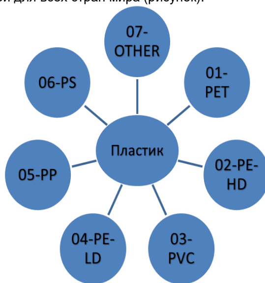
Рисунок – Система маркировки пластика, применяемая для его идентификации и сортировки после выхода из употребления
